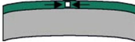
Abbildung 3: Schematische Zeichnung einer Schicht unter Druckspannung. Misst man die Verbiegung des Schicht/Substratverbundes, so lässt sich daraus die Spannung der Schicht bestimmen.
