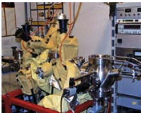
Abbildung 1: Ultrahochvakuumanlage mit AFM/C-AFM sowie Probenpräparationskammer (Ionenbeschuss, Probenheizung, Bedampfung).
