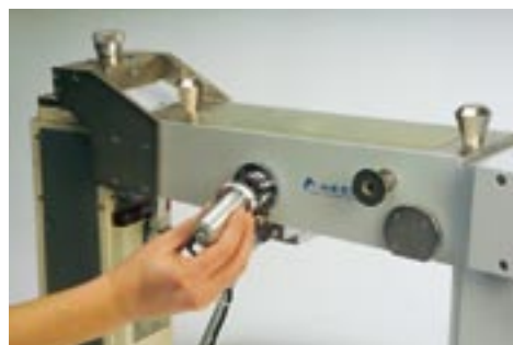
Abbildung 2: Rotation des Präparats mittels SpinCap-Probenhalterung: Dadurch werden Artefakte aufgrund von Sedimentation bzw. Flotation oder aufgrund von bevorzugten Orientierungen in Pulvern vermieden.
