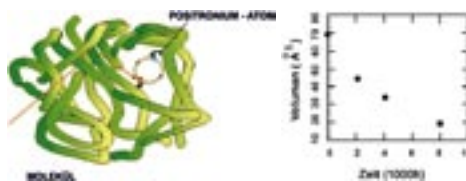
Abbildung 3: Bestimmung der Größe freier Volumen in einem Polymer durch Bildung und Annihilation von Positronium-Atomen (links). Rechts: Typische Abhängigkeit des freien Volumens von der Alterungszeit in Polymeren.
