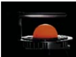
Abbildung 2: Heizkammer DHS 900 (Fa. Anton Paar) zur Erweiterung des Zugänglichkeitsbereiches für Spannungsuntersuchungen bei erhöhten Temperaturen.
