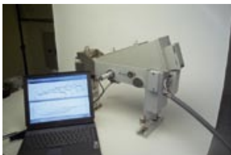
Abbildung 1: HECUS System-3 SWAXS – Klein- und Weitwinkelkamera mit zwei linearen ortsempfindlichen Detektoren: Datenerfassung in Echtzeit.
