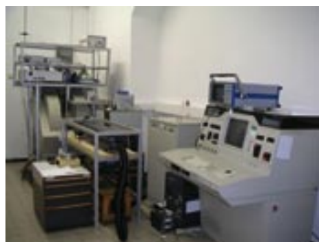
Abbildung 2: EPR-Spektrometer mit Magnet, darüber die Mikrowellenbrücke und die Konsole. Im Vordergrund sieht man noch einen Nd-YAG-Laser, welcher zur Erzeugung von Radikalen benutzt werden kann.
