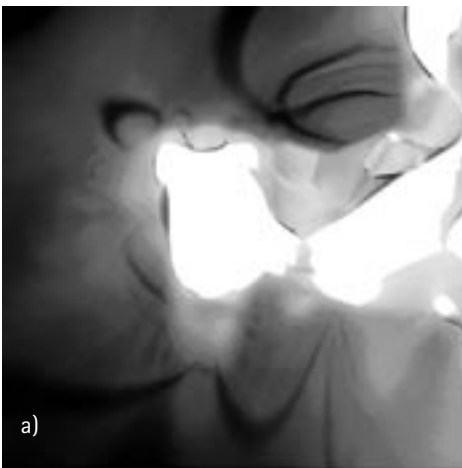
Abbildung 2: STEM-Bilder eines Silizium-Einkristalls: a) BF, b) HAADF.
