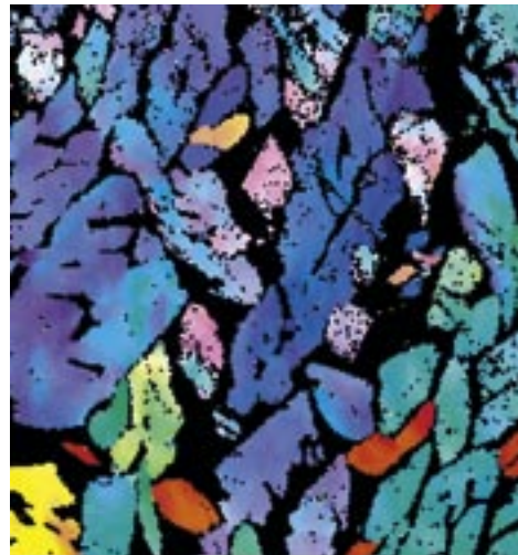
Abbildung 2: Kristallographische Orientierung von Austenit in einer Schweißnaht (Elektronenrückstreuung im Rasterelektronenmikroskop; blau = 111-Orientierung).
