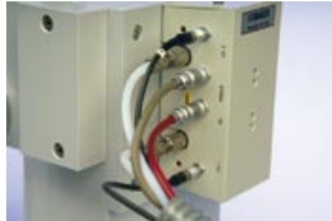
Abbildung 3: Der lineare ortsempfindliche Detektor: Datenerfassung in Echtzeit, einfacher und zuverlässiger Betrieb.
