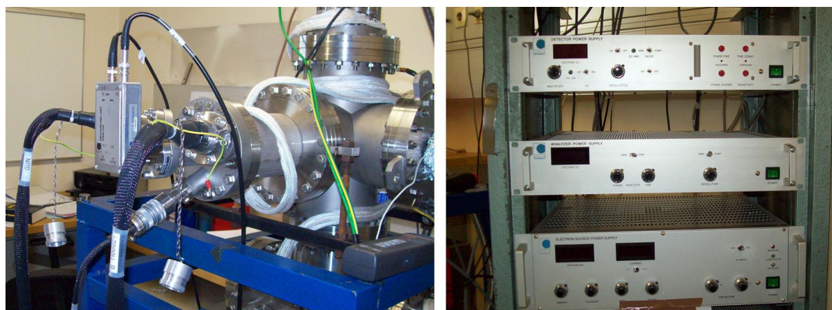
Abbildung 3.20: System der Firma Staib Instruments. Links: Vakuumkammer mit angebautes Augerspektrometer. Die Einheit besteht aus einer Elektronenkanone, einem Zylinderanalysator und einem Sekundärelektronenvervielfacher. Am Flansch des SEV ist eine Elektronikbox angebaut. Rechts: Energieversorgung, Steuerung und Signalverarbeitung des Augerspektrometers. Ganz oben ist die Versorgung des SEV angebracht. In der Mitte befindet sich die Steuereinheit des Zylinderanalysators, und unten ist die Versorgung der Elektronenkanone ersichtlich. Das System wird ergänzt durch einen Computer für die Datenaufzeichnung und Steuerung aller Komponenten.
