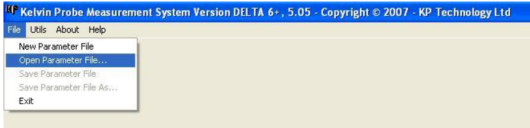
Fig. 10.9: Click File – Open Parameter File to open an existing parameter file and File – New Parameter File to create a new parameter file.
