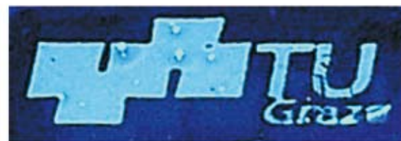
Abb. 2: Fluoreszierende Oberflächenschichten nach UV-lithographischer Strukturierung unter Verwendung einer Kontaktmaske.
